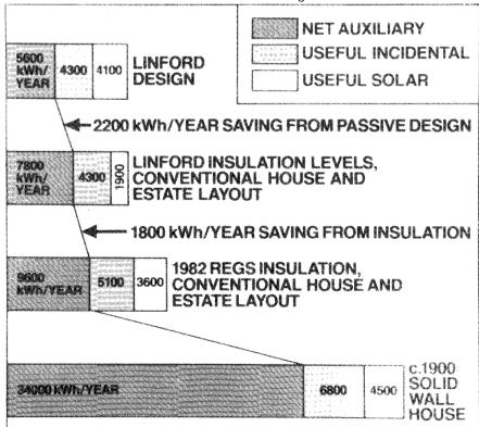
Passive Solarbaumerkmale tragen etwa 50 % zur Gesamtverbesserung gegenüber konventionellen modernen Bauweisen bei. Der Vergleich mit einem Altbau zeigt, wie wirksam energieeffiziente Bauausführung sein kann. (BFF)
