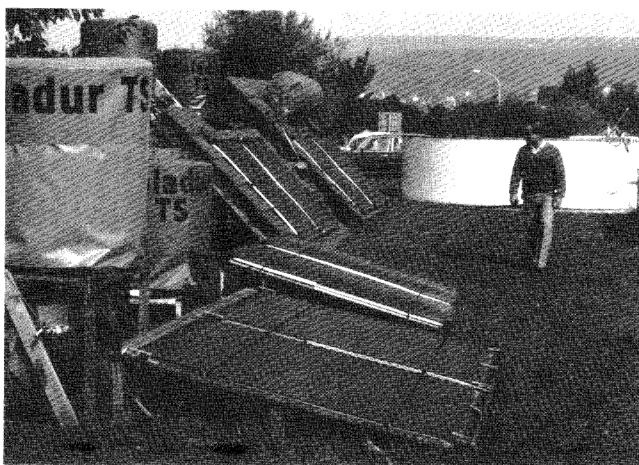
Thermosyphonanlagen von Wülfing und Hauck, zu Versuchs- und Vorführzwecken aufgestellt auf dem Werksgelände in Kaufungen bei Kassel; im Hintergrund ein frei aufgestelltes Schwimmbecken, das ebenfalls von dieser Firma hergestellt wird.
