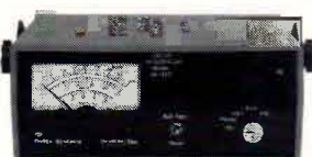
Solar-Integrator Modell SI-377 integriert die Meßwerte der Solarzelle
