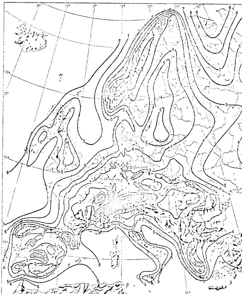
Bild 2: Isoventkarte von Europa (Linien konstanter mittlerer Windgeschwindigkeit)
